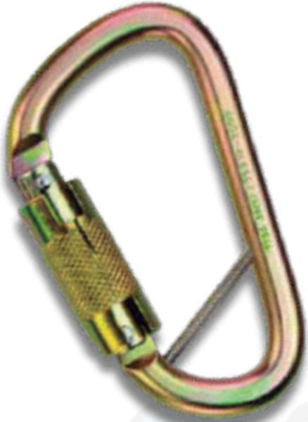
Mosquetón en "D" con apertura de un cuarto de vuelta y cierre automático, fabricado en acero forjado de alta resistencia (con acabado cromado amarillo).
